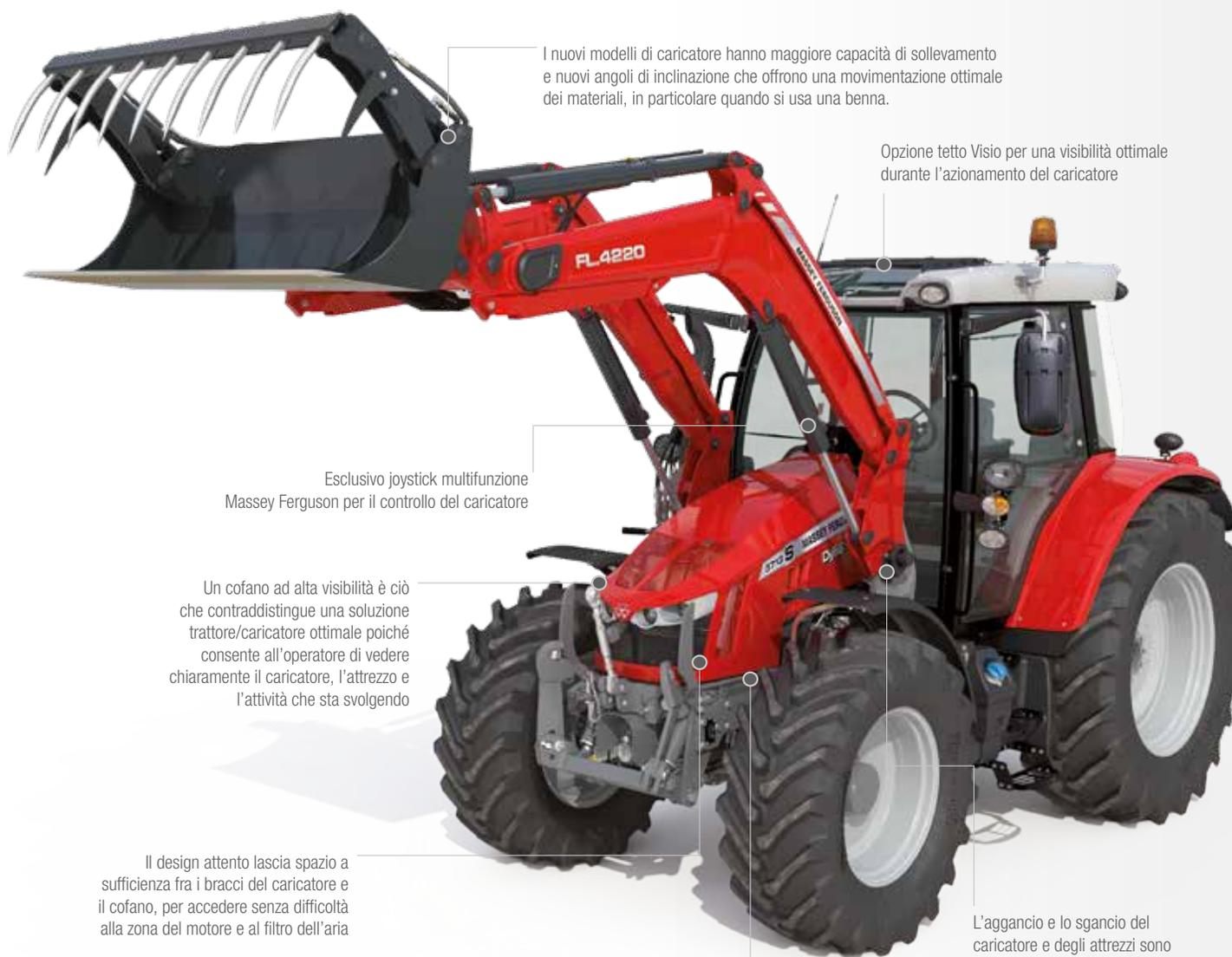
I nuovi modelli di caricatore hanno maggiore capacità di sollevamento e nuovi angoli di inclinazione che offrono una movimentazione ottimale dei materiali, in particolare quando si usa una benna.
