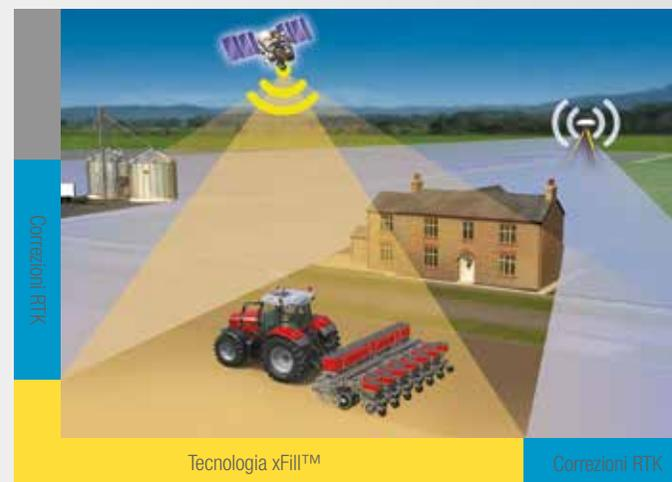
In caso di perdita del segnale a causa della conformazione del terreno, Auto-Guide™ continuerà a operare in maniera affidabile per un massimo di 20 minuti senza un segnale di correzione grazie alla tecnologia Trimble®-xFill™.
