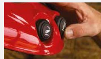
**Controllo della velocità di abbassamento del sollevatore** - Per prestazioni e sicurezza ottimali, incluso un meccanismo di bloccaggio per il trasporto
