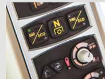
Selezione della velocità della PDF elettroidraulica
