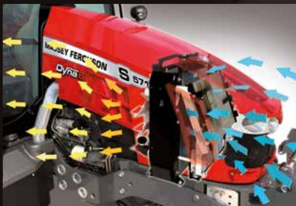
Grazie alle griglie ampie e allo spazio tra i componenti, i radiatori ricevono tutta l'aria fresca di cui necessitano per garantire la massima efficienza di raffreddamento.
