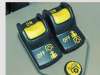
L'interruttore montato sulla console di destra consente un facile controllo da parte dell'operatore
