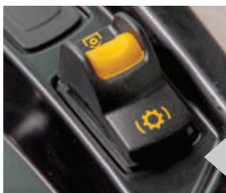
L'innesto della PDF è sempre elettroidraulico e usa lo stesso interruttore di sicurezza a 3 posizioni (Acceso, Spento e Blocco/freno).
