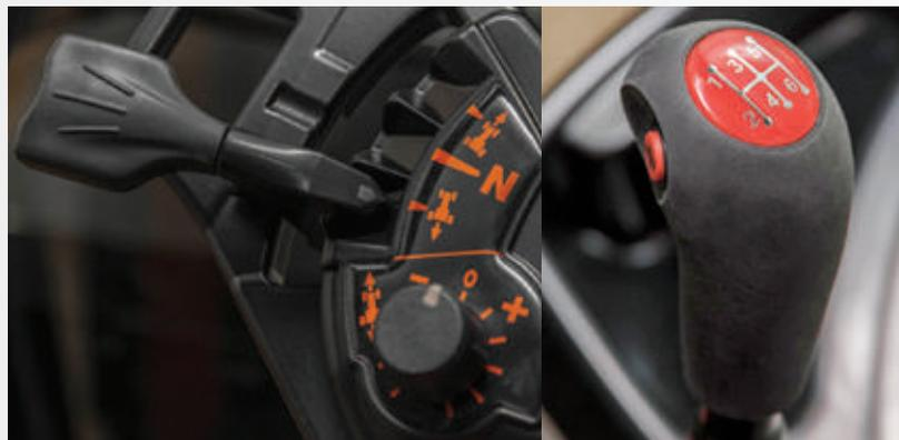
La leva Power Control opzionale, montata sul lato sinistro, garantisce un azionamento pratico e intuitivo in tre posizioni grazie a una trasmissione d'avanguardia. L'operatore può passare dalla marcia avanti alla retromarcia e viceversa e mettere in folle. E per una maggior precisione, la risposta dell'inversore può essere regolata grazie al Comfort Control, la soluzione ideale per le operazioni con caricatore frontale.
