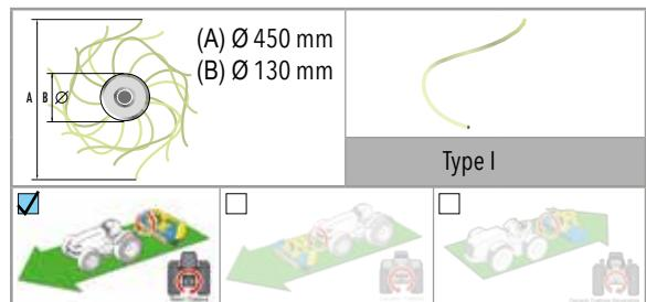
Il castello indipendente è un telaio autoportante dotato di diserbatrice meccanica, una macchina dedicata alla pulizia attorno al fusto delle piante e degli interfilari, senza provocare danni alla corteccia.
