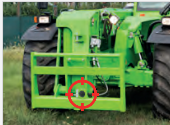
Sensore posto sulla zattera
