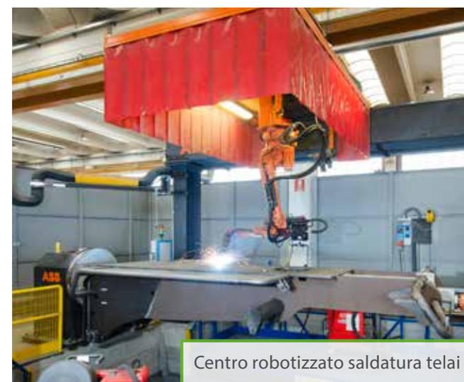
Centro robotizzato saldatura telai
