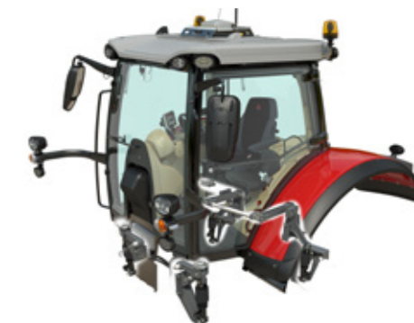
CABINA CON SOSPENSIONE A QUATTRO PUNTI per un comfort extra.
