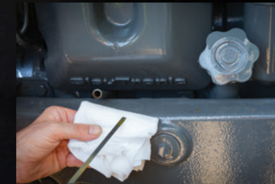
Il design affusolato del cofano e l'assale anteriore assicurano un comodo accesso ai filtri dell'olio motore e all'astina di livello.
