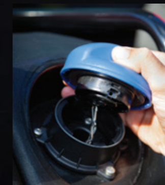
Il serbatoio dell'AdBlue® è stato posizionato con attenzione per migliorare l'isolamento alle alte e alle basse temperature. Il riempimento di entrambi i serbatoi è semplice e comodo.
