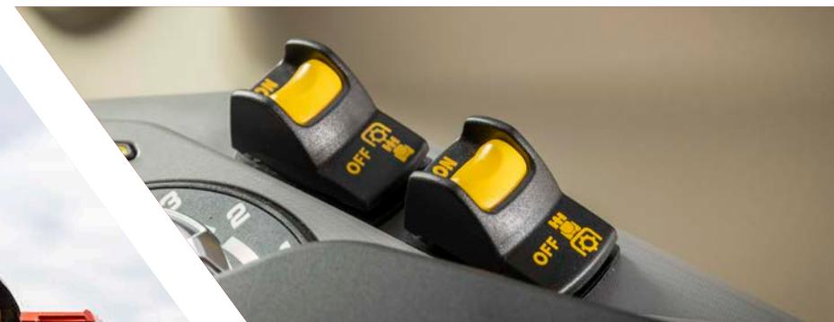
Selezione elettroidraulica della velocità della PTO
