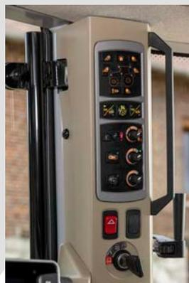
Un controllo elettronico accurato fornisce operazioni di sollevamento comode e semplici. Il potenziometro ELC è attentamente posizionato alla destra dell'operatore per un utilizzo facile e comodo, fornendo un controllo accurato della profondità dell'attrezzo come dell'abbassamento e del sollevamento del sollevatore.
