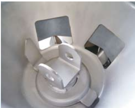
Regolazione quantità da distribuire Adjustment of the distributed amount Réglage de la quantité à distribuer Einstellung der zu verteilenden Düngermenge Regulación de la cantidad a distribuir
