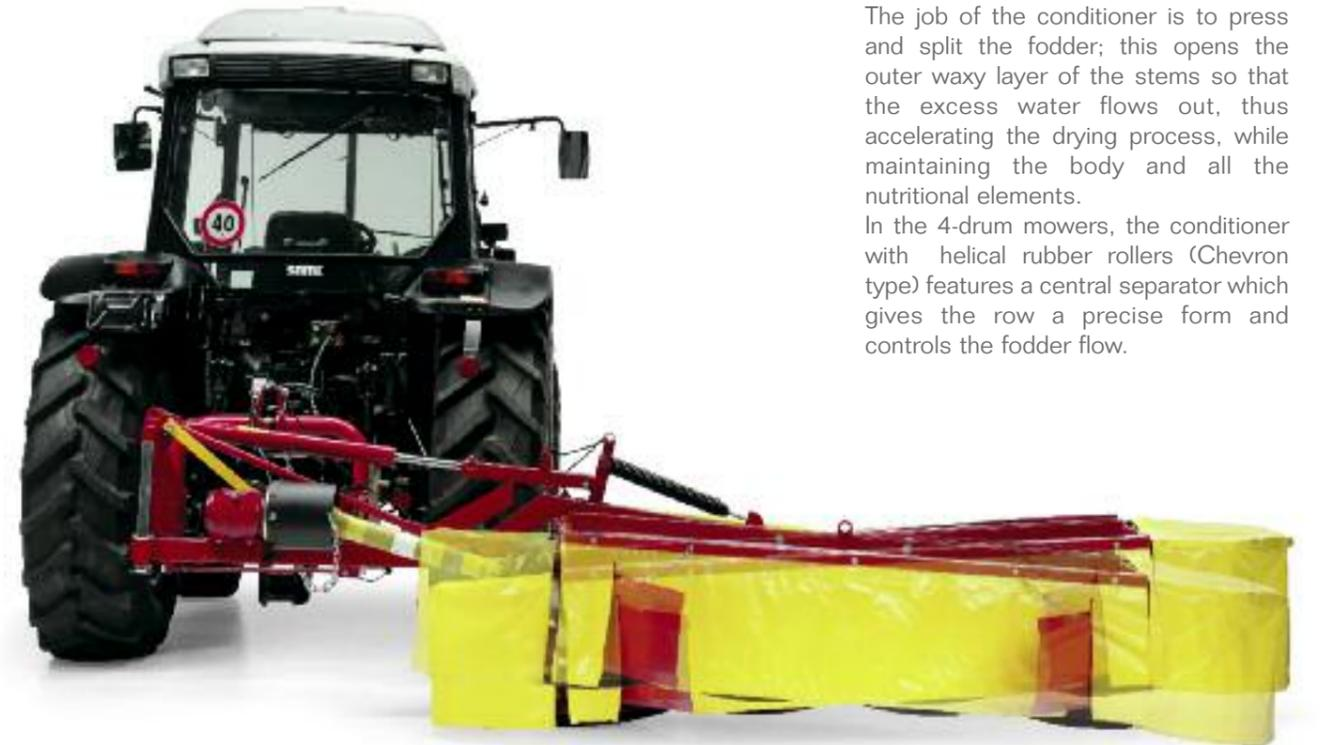
Il lavoro coordinato dell'attacco centrale con doppio movimento oscillante e della molla di compensazione permette alla falciatrice di adattarsi al terreno e di scaricare il peso sul trattore.
