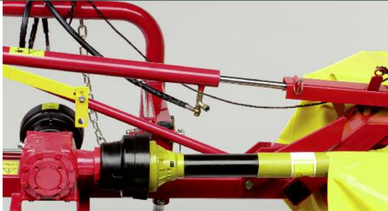
Il sollevamento dell'elemento laterale avviene tramite pistoni idraulici e un ulteriore gancio di sicurezza meccanico assicura la chiusura della falciatrice durante la marcia.
