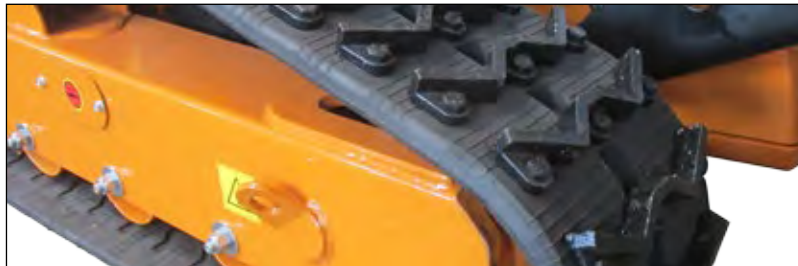
Cingoli Chiodati (consigliato per pendenze > 30°) / Steel-Studded Tracks C/W Spikes Set (recommended for inclinations > 30°) / Raupen Metall-Stegen + Spikes (empfohlen für Neigung > 30°) Chenilles Avec Clous (recommandé pour pente supérieur a 30°) / Orugas con Clavos (aconsejado para pendientes > 30°)
