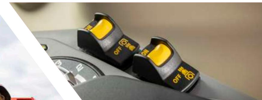
Selezione elettroidraulica della velocità della PTO
